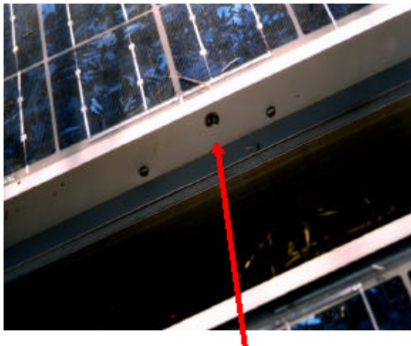
Photo 5: Amorçage entre un conducteur actif et le cadre du module
